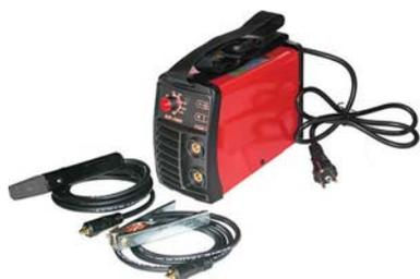
Saldatrici, professionali, elettriche in corrente alternata monofase costruite secondo le norme EN 60974-1/EN 60974-10. Raffreddamento forzato ad aria per uso continuo. Regolazione elettronica continua della corrente mediante manopola con scala graduata. Protezione automatica contro il surriscaldamento con riavvio automatico.
